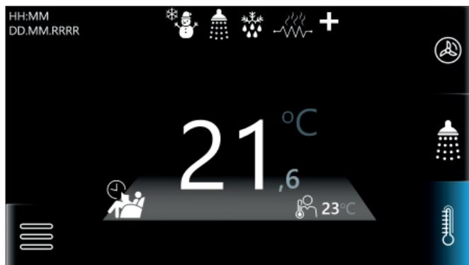
Funzione termostato, che usa la sonda interna all', per misurare la temperatura della stanza. Attivando questa funzione, la sonda interna sarà utilizzata per attivare o disattivare la pompa di calore.
